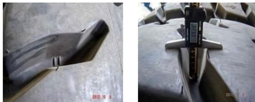
Индикатор износа большинства шин находится в канавке протектора в обеих плечевых зонах шины на внешней и внутренней стороне.
