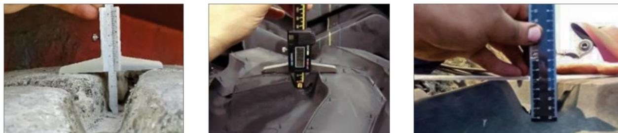
Показания глубиномера (штангенциркуля или линейки) должны быть разборчивые. Для замера щуп глубиномера (штангенциркуля) или линейка устанавливается в индикатор износа шины или рядом с ним в зависимости от его формы.
